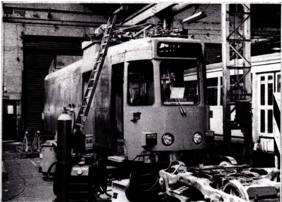
Mw TS 9094 tijdens zijn verbouwing tot onderzoeks- rijtuig van de boven- leiding, Jumet, 4 juni 83
